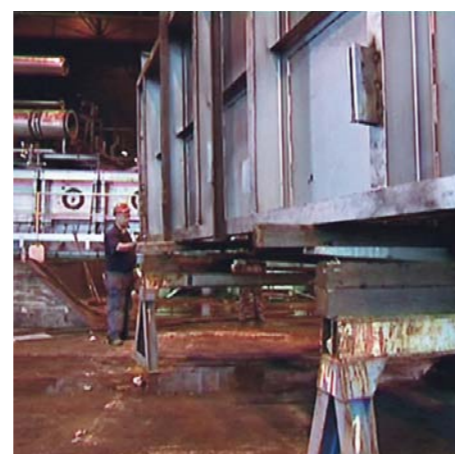
7. 炉子设备和烧嘴通常都整体组装好后运抵现场，从而减少安装时间。
