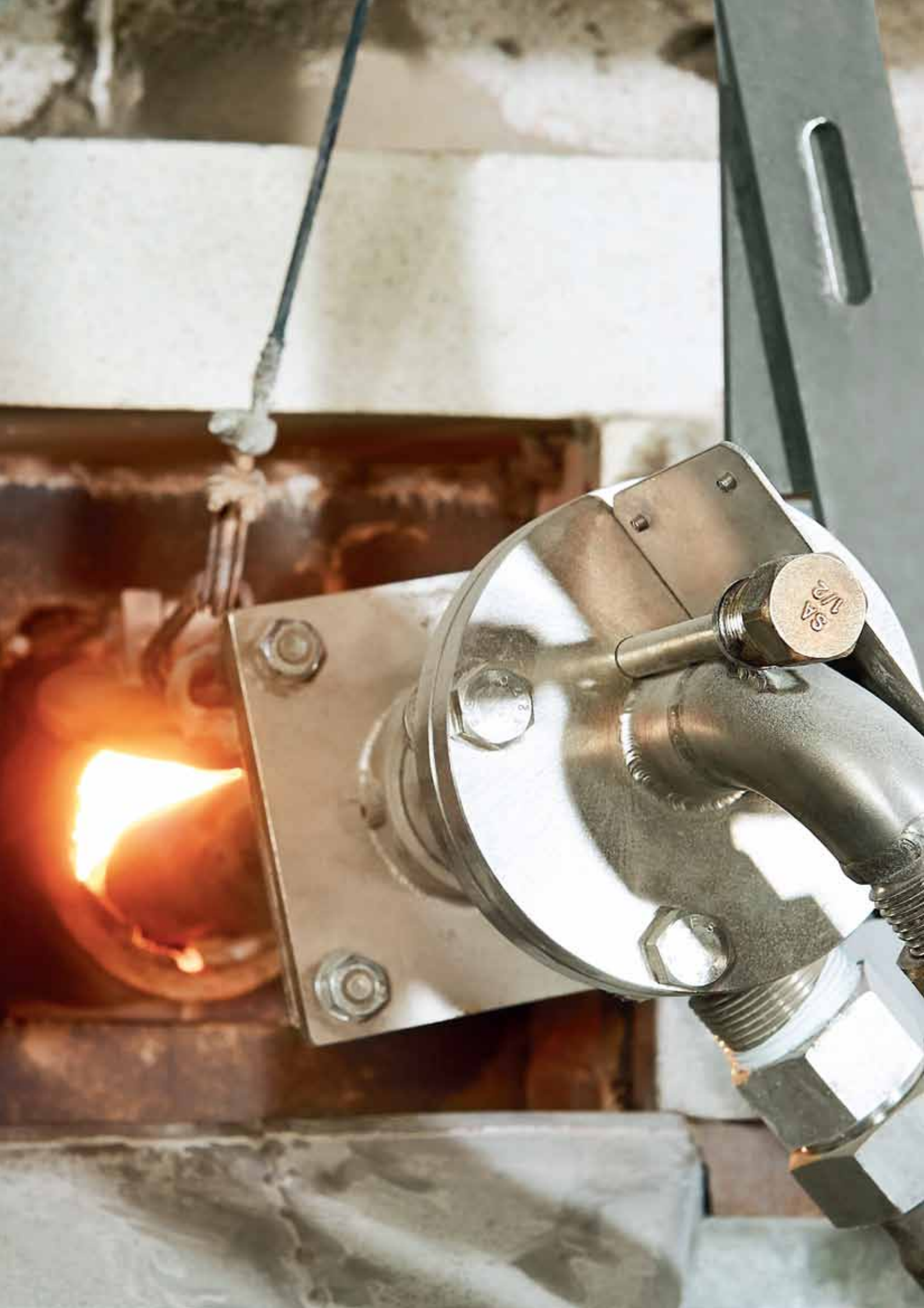
图1：氧燃料燃烧，减少氮气含量
