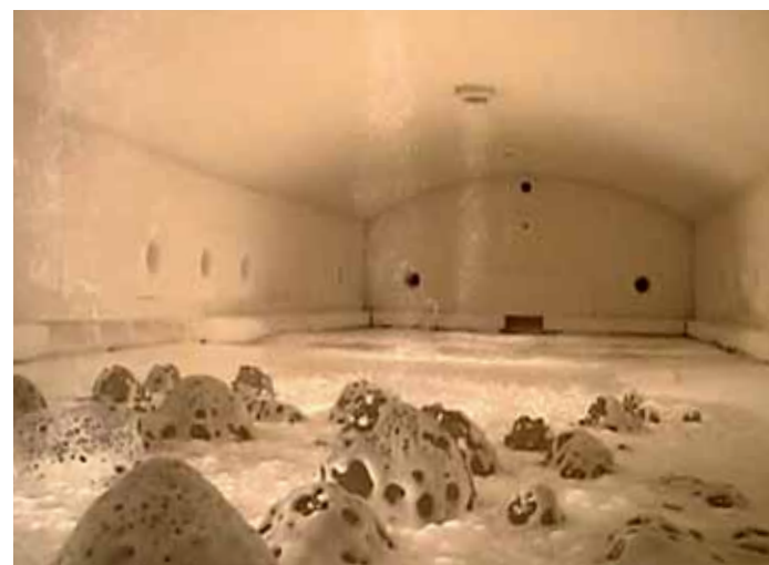
运行中的COROX®对流玻璃熔化
