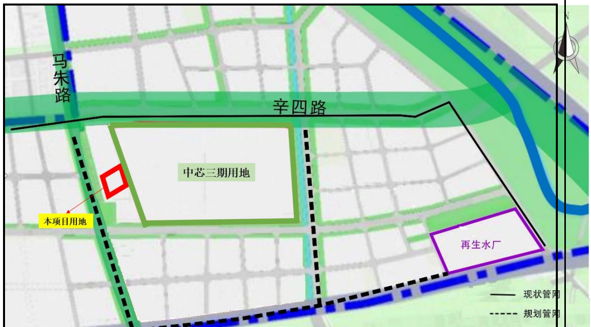
图 7 本工程周边市政污水管网规划图
