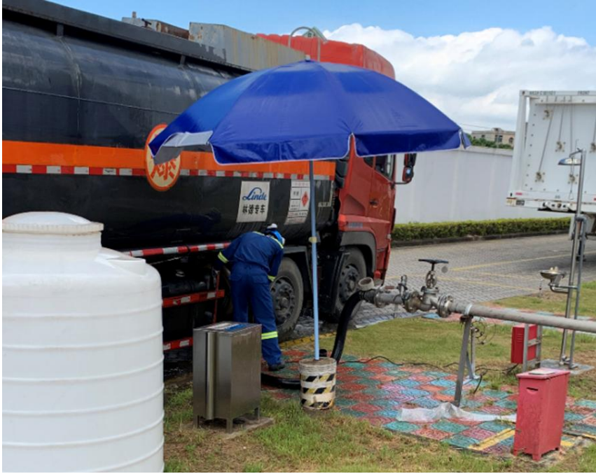
(3) 中控人员穿戴好劳保用品，关闭甲醇槽车卸料阀。
